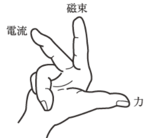
図 1.4 フレミングの右手の法則
